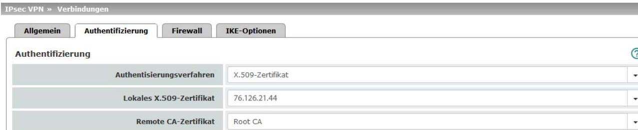
Bild 1-3 mGuard VPN-Konfiguration – Authentifizierung
